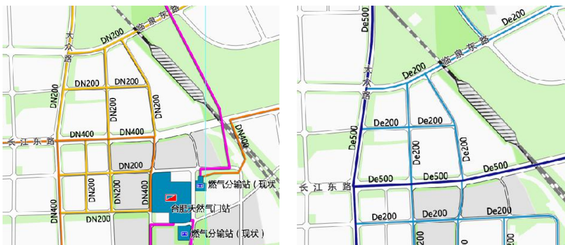
图 7 供气工程、供热工程规划图
