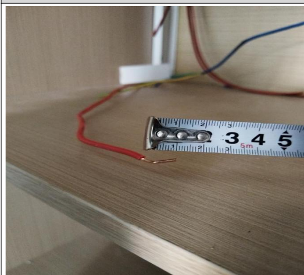
图 3-5 相线端导电体长度
